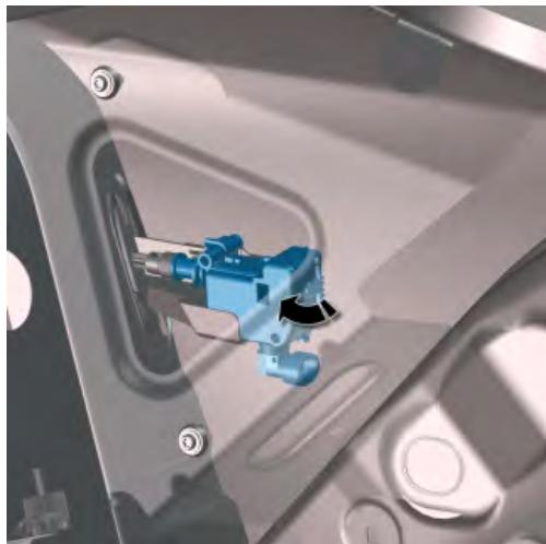
安装执行器电动机并将其连接到锁销。
