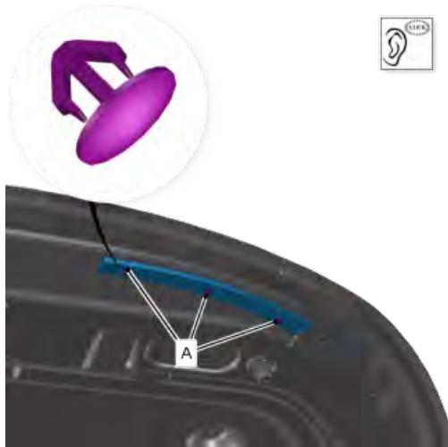
安装发动机罩密封件。
