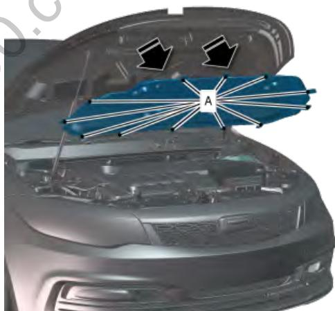
从 12 个夹点 (A) 处卸下发动机罩隔热垫。
