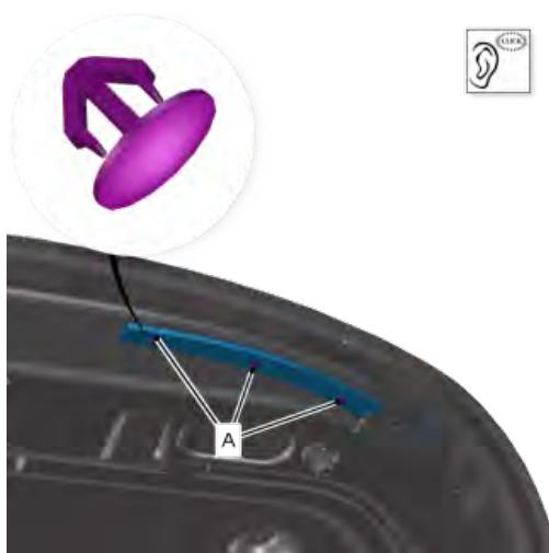
安装左侧发动机罩密封件。
