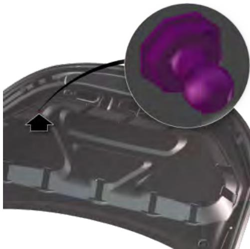
拆下发动机罩气压杆栓。
