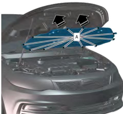
在 12 个夹点 (A) 处安装发动机罩隔热垫。
